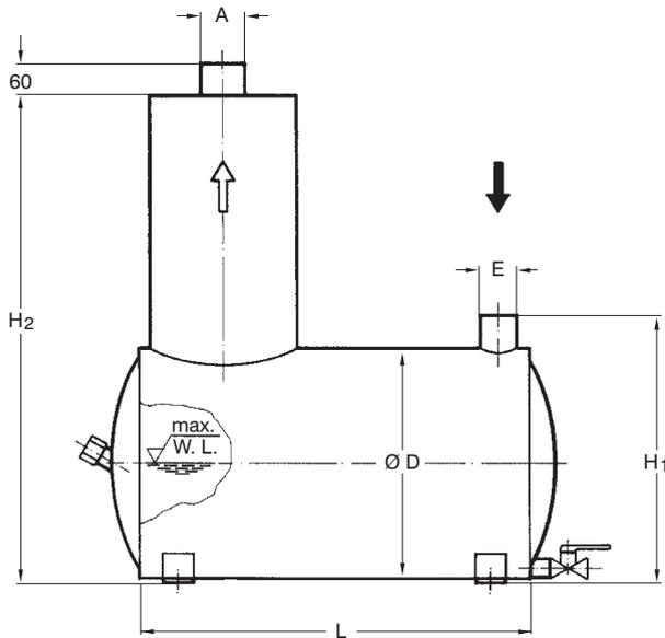
Abgaswäscher werden zur Reinigung der Abgase von Dieselmotoren verwendet. Durch die Herabsetzung der Gastrübung aus Ruß, Ölnebel und anderen Abgasbestandteilen wird vor allem beim Start und beschleunigen eine deutliche Verbesserung der Abgasqualität erreicht. Auch wasserlösliche Verbindungen werden dem Abgas beim Durchströmen des Wasserbades entzogen. Die Geruchsbelästigung wird vermindert.
